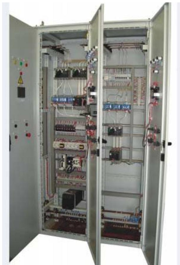
Схемы АВР разработаны на базе микропроцессорной техники с возможностью интеграции в систему АСУ электроснабжения по промышленному протоколу Modbus. Данные НКУ применяются для комплектования щитов станций управления (ЩСУ) шкафами ввода с АВР.
